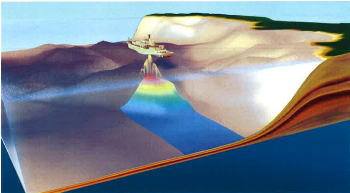
Havbunnskartlegging med multistråleekkolodd. For hver seilingslinje kartlegges det en sektor av havbunnen.
