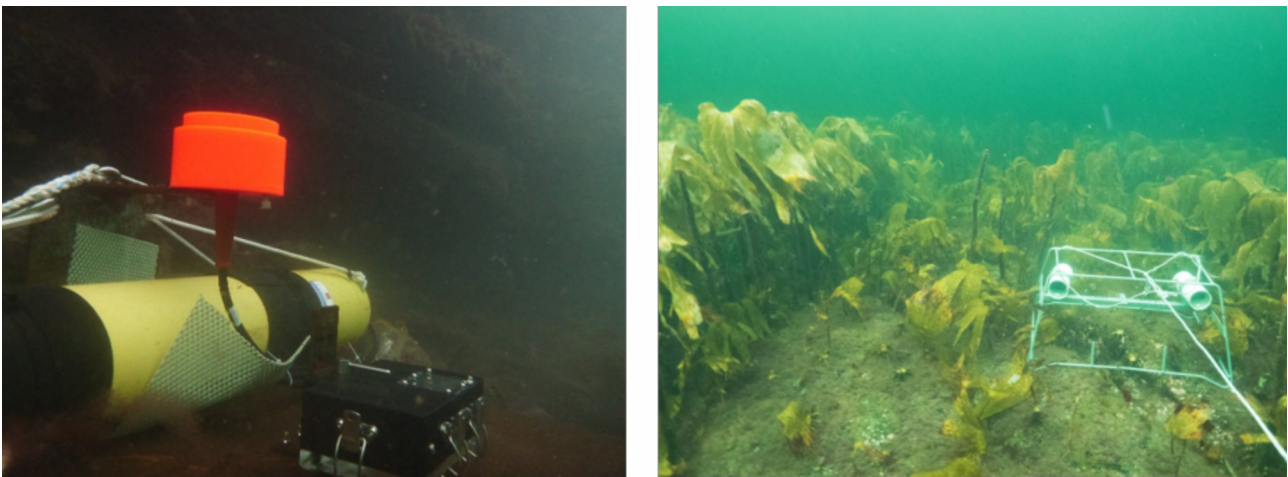
Fig. 11. Vertikalt rettet bunnstående ekkolodd (WBAT) og stereovideokamera ble testet for å undersøke fiskesamfunn i tett vegetasjon.
