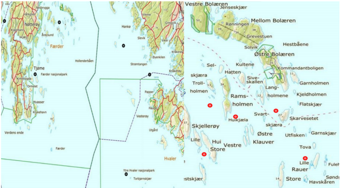
Fig. 14. Plasseringen av vannstasjoner for innhenting av parametere for miljøtilstandsbeskrivelse (venstre panel, sorte punkter) og plassering av sedimentfeller (høyre panel, røde punkter).
